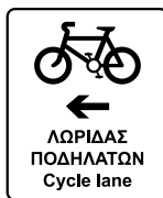
Προειδοποίηση ότι πλησιάζουμε συμβολή με ποδηλατολωρίδα που παρέχει προτεραιότητα στη διακίνηση ποδηλατών στον κύριο δρόμο που έχει κατεύθυνση σύμφωνα με το βέλος
