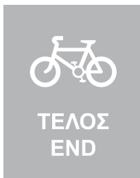
Σήμανση οδοστρώματος που υποδεικνύει το τέλος της ποδηλατολωρίδας.
