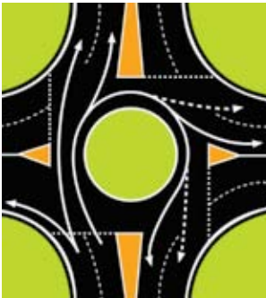
Κυκλικός κόμβος με δύο λωρίδες εισόδου
