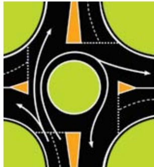
Κυκλικός κόμβος με δύο λωρίδες εισόδου
